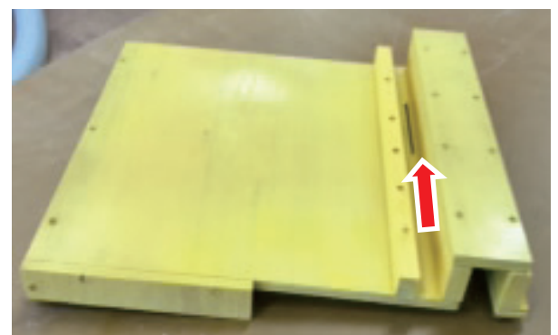
図4 補助具「溝切りガイド」(矢印の箇所が刃の位置)
