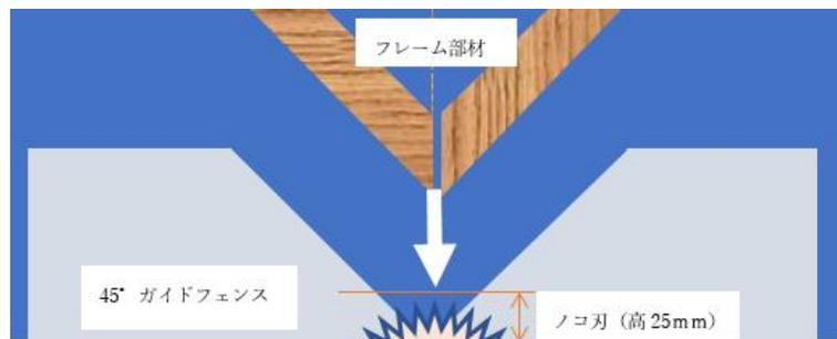
図1 補助具の内部の説明図
