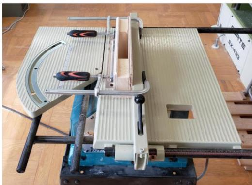
【写真2】 クランプで補助具を固定した状態
